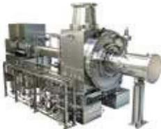
**Turbokompressoren mit Direktantrieb für Polyethylen und Polypropylen, Verdichtungsdruck bis 120 MW/43 bar**
